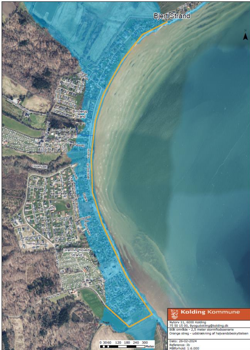
Oversigtskort. Blå markering viser oversvømmelsens udbredelse ved en vandstand på 2,5 m over normal vandstand. Den orange linje viser udstrækningen af den foreslåede kystbeskyttelse.
